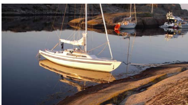
H-Båt , Motor: GS10. Batteri: Bly 24V, 100 Ah Prestanda: 4 kn - 31/2 h, 6 kn-20 min
