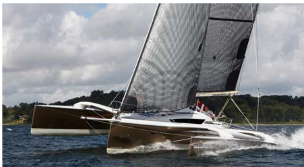
Dragonfly 32 , Motor: GS18. Batteri: Litium 24V, 320 Ah Prestanda: 4 kn - 11 h, 6 1/2 kn - 1 1/2 h
