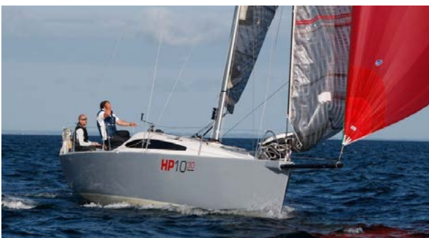
HP1030 , Motor: GS10. Batteri: Bly 24V, 200 Ah Prestanda: 4 kn - 7 h, 6 kn - 40 min
