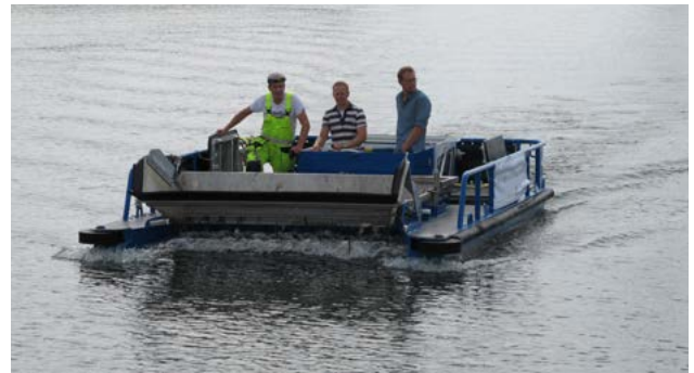
RenStröm , Motor: 2xGS18. Batteri: Litium 48V, 360 Ah Prestanda: 4 kn - 16 h, 5 1/2 kn - 2 h
