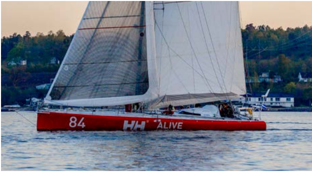
Open 60 , Motor: E35P. Batteri: Litium 48V, 160 Ah Prestanda: 4 kn - 31/2 h, 5 kn - 1 h
