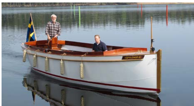
Säfvelången II , Motor: GS18. Batteri: Bly 48V, 200 Ah Prestanda: 4 kn - 11 h, 6 kn - 2 h
